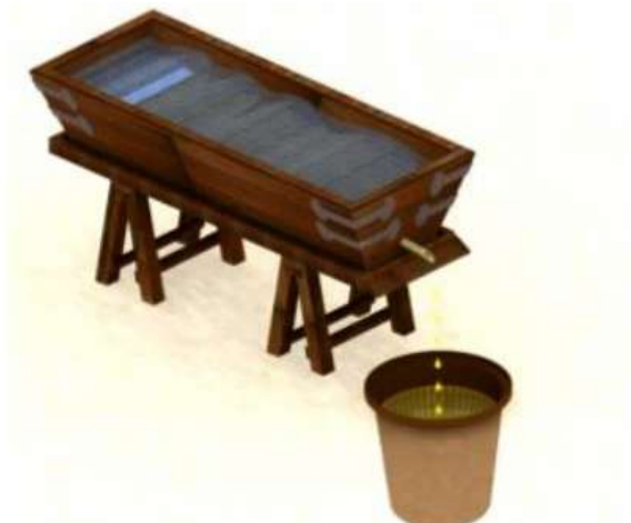
Figura 7. Artesa tipo aragonesa. Eran las coladeras que se usaban en las salitrerías de Alcázar para obtener la lejía que posteriormente se llevaría a las calderas. Modelada por Estefanía Muñoz a partir de los modelos de Martínez Rueda (1833).
