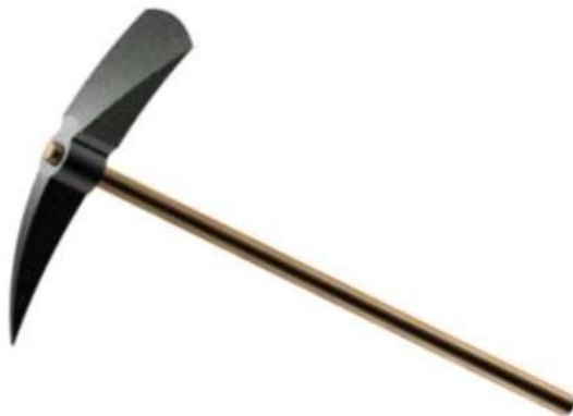
Figura 1. Azada utilizada en la fábrica de salitre. Elemento básico para extender los tendidos sin comprimir. Modelada por Estefanía Muñoz a partir de los modelos de Martínez Rueda (1833).
