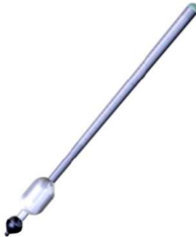
Figura 2. Aerómetro o pesa-licor. Modelada por Estefanía Muñoz a partir de los modelos de Martínez Rueda (1833).
