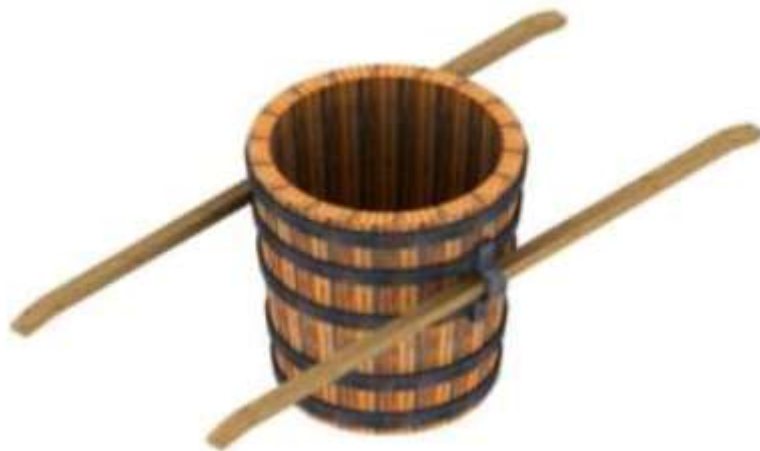
Figura 14. Cubo de trasiego utilizado para transportar el salitre cristalizado a botazos donde eliminar las impurezas. Modelada por Estefanía Muñoz a partir de los modelos de Martínez Rueda (1833).
