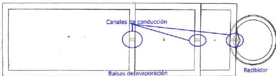
Figura 10. Esquema de las balsas de evaporación al sol, los canales de conducción y el receptor de lejías que serían llevadas a las calderas. Modificado de Martínez Rueda (1833).
