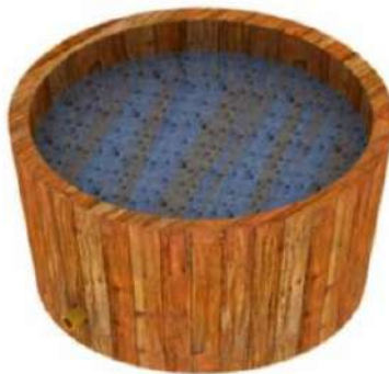
Figura 4. Coladera tradicional con espita en donde se hacían las pruebas de las raeduras para comprobar la graduación de las lejías de salitre. Se llenaba de tierra y agua y se dejaba reposar seis horas, saliendo la lejía a través de una espita. Modelada por Estefanía Muñoz a partir de los modelos de Martínez Rueda (1833).
